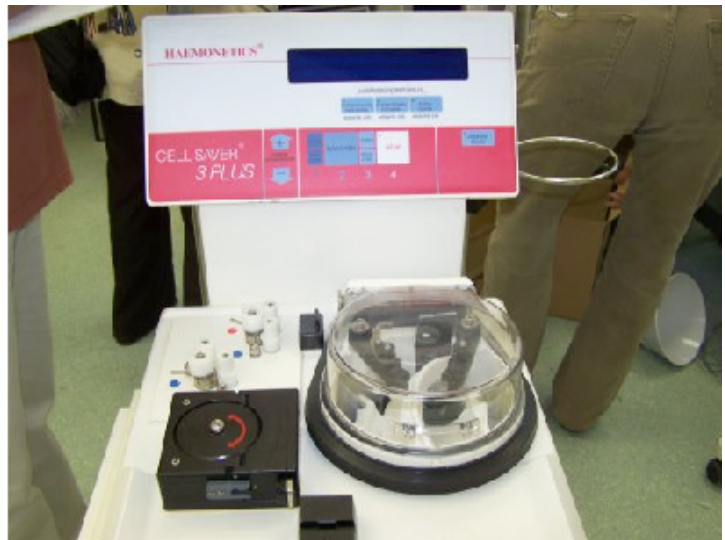
Εικόνα 6.67 Η αρχή λειτουργίας των διατάξεων ΔΚΔ είναι η Διάφορική Φυγοκέντρωση. Οι συσκευές πραγματοποιούν αυτοματοποιημένα, με ασφάλεια και ταχύτητα την «χειροκίνητη» διαδικασία που γίνεται στη ρουτίνα της Αιμοδοσίας [100].
