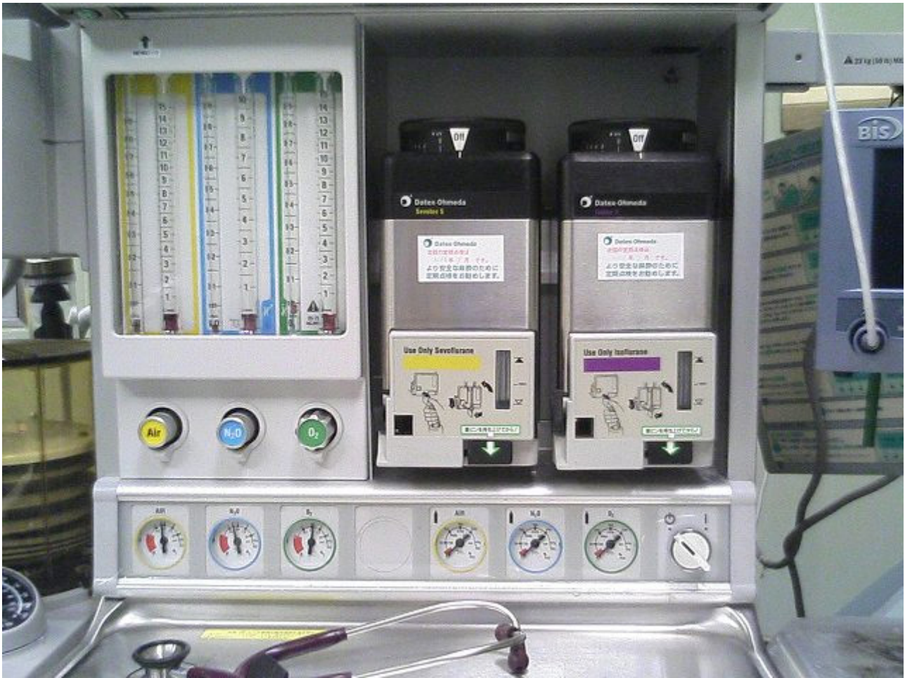
Εικόνα 5.13 Ροόμετρα Αέρα, N_2O και O_2 και Εξαερωτές Σεβοφλουρορανίου και Ισοφλουρορανίου: Ignis, https://commons.wikimedia.org/wiki/File:Vaporizer.jpg
