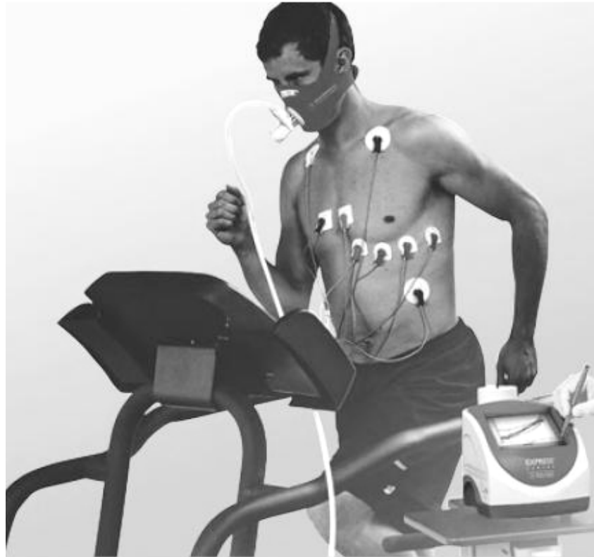
Εικόνα 3.2 Χωρητικός μετατροπέας. P1, 2: οπλισμοί του πυκνωτή, F: φύλλα με σχισμές, του οποίου τα τμήματα κάμπτονται προς κατεύθυνση της ροής και έτσι μεταβάλλουν τη χωρητικότητα [1]. Δεξιά: Σύγχρονο σύστημα Εργοσπιρομετρίας, δηλαδή συνδυασμού ΗΚΓ & Σπιρομετρίας [3].
