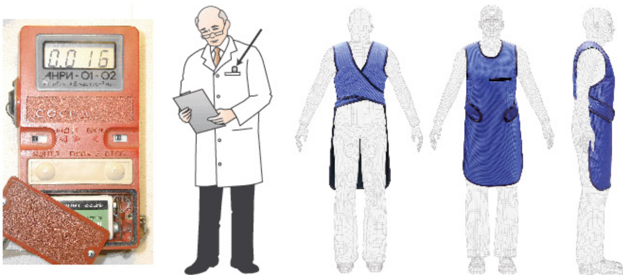
Εικόνα 6.83 Εξοπλισμός Ακτινοπροστασίας από αριστερά: Φορητό Δοσίμετρο, Ατομικό Δοσίμετρο (TLDs) και προστατευτική ενδυμασία με Μόλυβδο (εμπροσθέλλες κλπ.) για χρήση π.χ. σε .Χειρουργικές Διαδικασίες με Ακτινολογική Καθοδήγηση [123].
