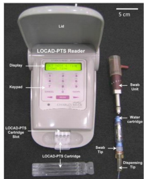
Εικόνα 3.54 Αριστερά: Ένα φορητό σύστημα ανάπτυξης εφαρμογών και δοκιμών στη Τεχνολογία Lab-On-a-Chip Applications Development Portable Test System (LOCAD-PTS), το οποίο εγκαινιάστηκε στο Διάστημα, στις 9 Δεκεμβρίου 2006, για τον χειρισμό του δείγματος. Αποτελείται από (Α) μια «πατασβούρα» ή πιπέτα και (Β) ένα κιτ επιχρίσματος, που αποτελείται από ένα φυσίγγιο νερού (W), το άκρον επίχρισης (S) και «μύτη» (tip) διανομής (D). Κάτω δεξιά: Το πλήρες σύστημα μέσα στο περιβλήμά του (βλ. NASA: https://commons.wikimedia.org/w/index.php?search=lab+on+a+chip&title=Special%3ASearch&go=Go&uselang=en )
